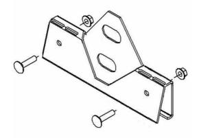
Снегозадержатель овальный для фальцевой кровли изготовлен из оцинкованной стали, а за счет зубчатого крепления, легко и надежно крепится на кровлю. Кронштейн на фальц не нарушает герметичность фальцевой кровли.
