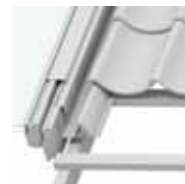
E-W Для кровельных материалов с высотой профиля до 120 мм (керамическая, цементно-песчаная черепица, профнастил, металлочерепица). Уклон крыши от 15° до 90°
